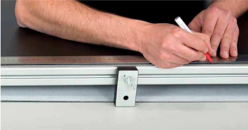
Während des Spannvorganges muss die vorliegende Transportbandspannung kontrolliert werden. Dies erfolgt mit Hilfe eines Stahllineals. Das Transportband muss hierfür frei liegen und darf nirgends geklemmt sein. Mit Hilfe des Stahllineals wird eine definierte Strecke auf dem Transportband markiert. Hierbei empfiehlt sich z.B. eine Strecke von 1000 mm, da die prozentuale Dehnung gemäß Tabellenvorgabe einfacher zu kontrollieren und abzulesen ist.
