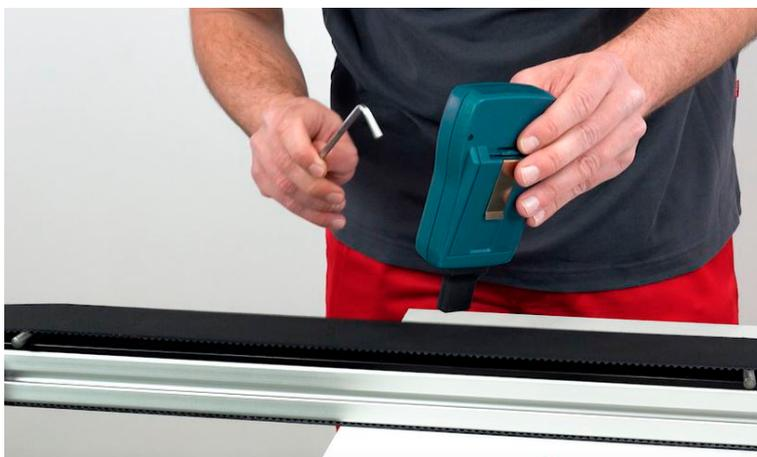
Mit Hilfe des Frequenzanalysegerätes wird die eingestellte Vorspannung über die Frequenz, mit der ein definierter Teilabschnitt des Zahnriemens durch Anschlagen schwingt, ermittelt. Für die notwendige Vorspannung von 0,1% muss bei einem Messabstand von 0,5 m (Abstand der dem Frequenzanalysegerät beiliegenden Zylinderstifte unterhalb des Zahnriemens) eine Frequenz von 50 Hz vorliegen.
