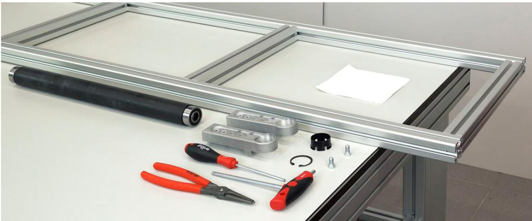
Dazu wird der Wellen-Spannring in den Antriebsbeschlag eingesetzt, welcher dem Motor später gegenüberliegt. Anschließend wird an der Motorseite die Positioniering von innen an der Befestigung durchgeschoben und verrastet.
