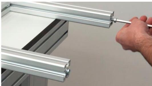
Die Antriebsumlenkung muss zunächst zusammengesetzt und befestigt werden.
