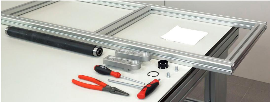
Dazu wird der Wellen-Spannring den Antriebsbeschlag eingesetzt, welcher dem Motor später gegenüberliegt. Anschließend wird an der späteren Motorseite der Positionerring von innen in der Befestigung durchgeschoben und verrastet.
