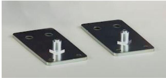
Im Anschluss werden die Lager beidseitig mit einem Schonhammer vorsichtig im Rohr D30 eingeschlagen. Die Laschen mit dem Rohr D30 werden dann geschützt durch das Kanalprofil 8 40x40 SE mit selbstfurchenden Schrauben zusammengebaut.
