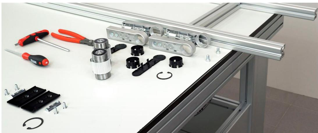
Dazu wird der Wellen-Spannring in den Antriebsbeschlag eingesetzt, welcher dem Motor später gegenüberliegt. Anschließend wird an der späteren Motorseite der Positionerring von innen in der Befestigung durchgeschoben und verrastet.
