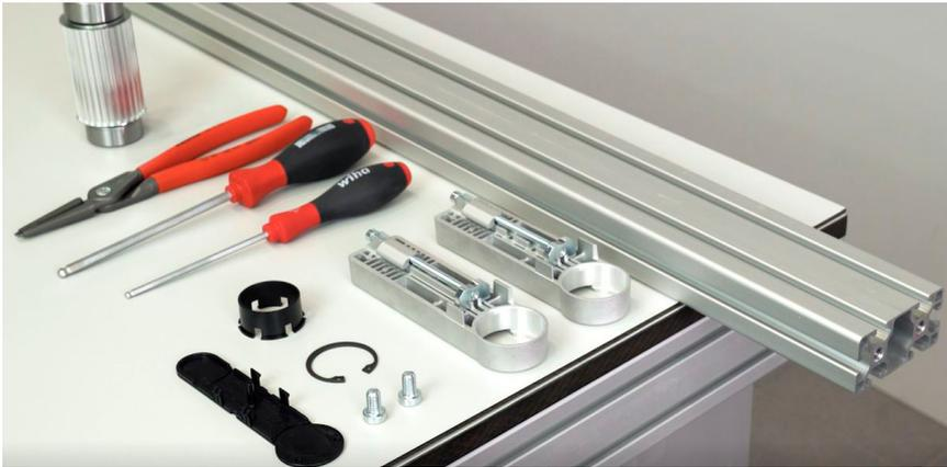
Die beiden Flachkopfschrauben M8x14 werden bis zur Anlage eingeschraubt. Mit ihrer Hilfe wird ein Zughaken in Position gehalten um den Antriebsbeschlagsatz 8 40 am Ende der Montage noch einzustellen.
