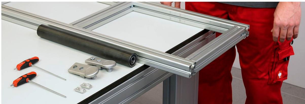
Bevor der Umlenkbeschlagsatz 8 40 am Profil montiert werden, muss jeweils eine Feinjustierung 8 in die seitliche Nut der Profile der Baureihe 8 geschoben.
