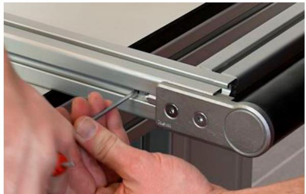
Die Umlenkung wird nach der Vormontage in die seitliche Nut der Profile geschoben und anschließend festgezogen.
