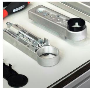
Die Lager der Antriebsrollen werden nun in die Antriebsbeschläge von Hand eingedrückt und anschließend als vormontierter Bausatz seitlich in die Nuten des Profils 8 bis zum Anschlag geschoben und handfest angezogen. Beim Einschieben muss darauf geachtet werden, dass der Zughaken in der Endlage richtig positioniert ist und nicht verdreht oder verklemmt ist. Hierzu dienen die Flachkopfschrauben M8x14.
