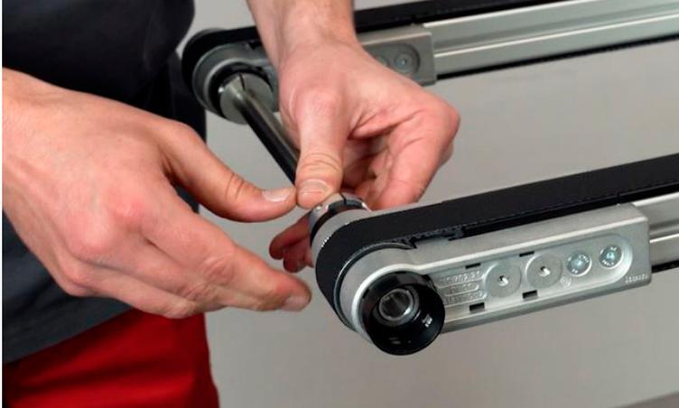
Sitzt das Synchronrohr spielfrei zwischen den Antriebsumlenkungen werden die Kupplungen fest mit dem Synchronrohr verschraubt.  $M_A = 4 \text{ Nm}$
