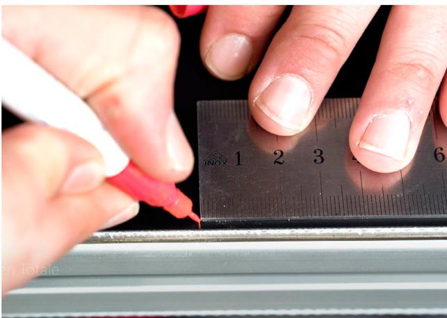
Während des Spannvorganges muss die vorliegende Transportbandspannung kontrolliert werden. Dies erfolgt mit Hilfe eines Stahllineals. Das Transportband muss hierfür frei liegen und darf nirgends geklemmt sein. Mit Hilfe des Stahllineals wird eine definierte Strecke auf dem Transportband markiert. Hierbei empfiehlt sich z.B. eine Strecke von 1000 mm, da die prozentuale Dehnung von 0,5% einfacher zu kontrollieren und abzulesen ist.
