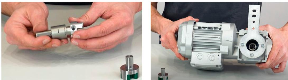
Die Motorachse mit Passfeder wird in einer der Kupplungshälfte durch Verschrauben verklemt und in das Kupplungsgehäuse gesteckt.
