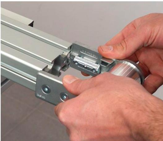
Der Umlenbeschlagsatz 8 80 wird nach der Vormontage in die seitlichen Nuten des Profils 8 40x40 bzw. des Profils 8 80x40 geschoben und anschließend festgezogen.  $M_A = 10 \text{ Nm}$
