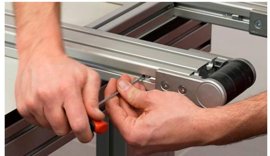
Die Umlenkbeschlagsätze 8 40 werden nach der Vormontage in die seitlichen Nuten des Profils 8 40x40 bzw. des Profils 8 80x40 geschoben und anschließend festgezogen.
