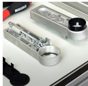
Die Lager der Antriebsrolle werden nun in die Antriebsbeschläge von Hand eingedrückt und anschließend als vormontierter Bausatz seitlich in die Nuten des Profils 8 40x40 bzw. Profil 8 80x40 bis zum Anschlag geschoben und handfest angezogen. Beim Einschieben muss darauf geachtet werden, dass der Zughaken in der Endlage richtig positioniert ist und nicht verdreht ist oder verklemt ist. Hierzu dienen die Flachkopfschrauben M8x14.
