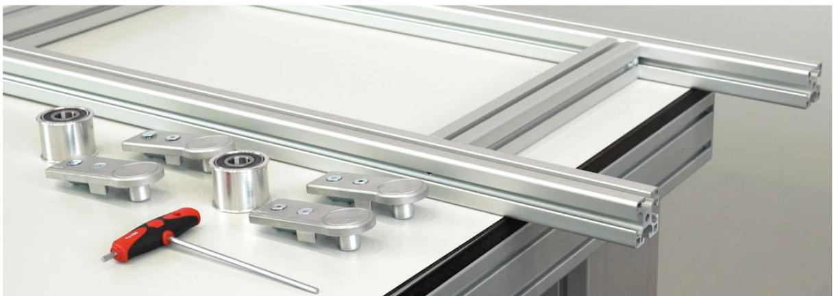
Die Umlenkrolle wird von Hand in die Umlenkungsbeschläge gedrückt bis diese zur Anlage kommt.
