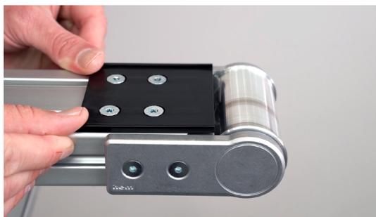
Die Montage der Ein-/Auslauf Führungsleiste an der Antriebsseite erfolgt genauso. Die Endposition ergibt sich hierbei nach der Montage der Führungsleiste im Anschluss an den nächsten Montageschritt
