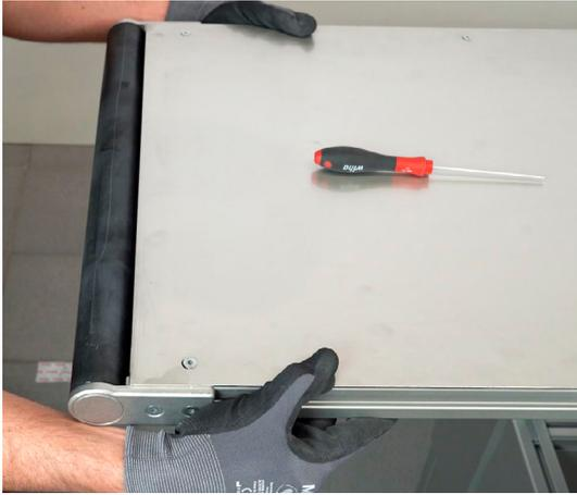
Anschließend werden die Senkschrauben fest angezogen.  $M_A = 5 \text{ Nm}$
