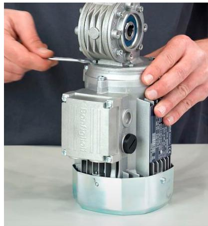
Die Sechskantschrauben anschließend mit einem Maulschlüssel SW8 fest anziehen.
