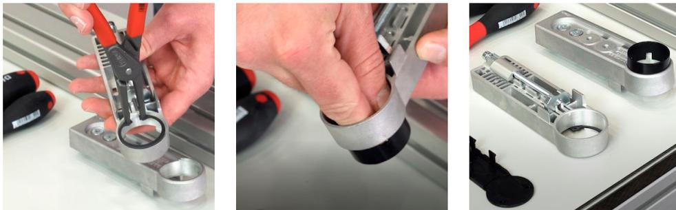
Die Lager der Antriebsrollen werden nun in die Antriebsbeschläge von Hand eingedrückt und anschließend als vormontierter Bausatz seitlich in die Nuten des Profils 8 40x40 bzw. des Profils 8 80x40 bis zum Anschlag geschoben und handfest angezogen.
