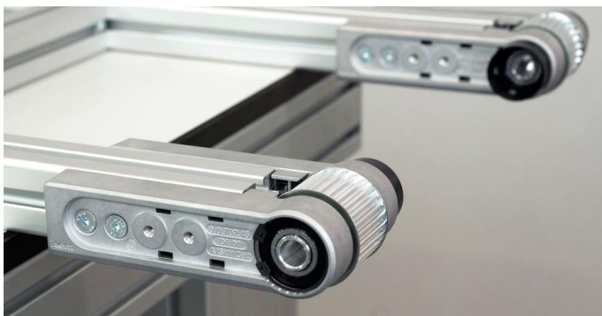
Die Lager der Antriebsrolle werden nun in die Antriebsbeschläge von Hand eingedrückt und anschließend als vormontierter Bausatz seitlich in die Nuten des Profils der Baureihe 8 bis zum Anschlag geschoben und handfest angezogen.
