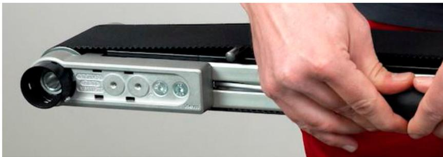
Das Transportband wird durch Drehen der Spannschrauben für eine prozentuale Dehnung von z.B. 0,5% somit auf 5/1000 der gesamten Transportbandlänge gespannt. Im Beispiel mit einer markierten Strecke von 1000 mm liegt die notwendige Vorspannung vor, wenn die Striche um 5 mm auf 1005 mm auseinander gewandert sind. Bei den Transportbändern mit 0,4% bzw. 0,3% prozentualer Dehnung ist die korrekte Vorspannung entsprechend bei einem Abstand der Striche von 1004 mm bzw. 1003 mm erreicht.
