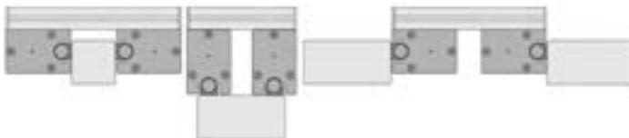
Die Laufrollenprofile bieten variable Befestigungsmöglichkeiten über Nuten der Baureihe 8, wodurch sich die Montage und das Ausrichten auf Profilen oder Aufspannplatten wesentlich vereinfacht.
