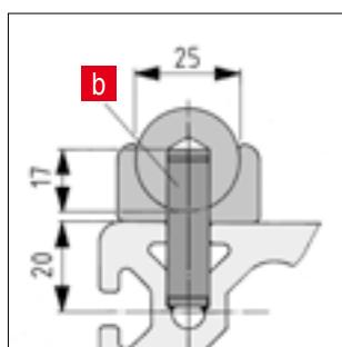
Um ein Herauswandern der Welle zu verhindern, sollte sie mit Zylinderstiften fixiert werden. Die Bearbeitung von Welle, Wellenklemmprofil und Trägerprofil erfolgt vorzugsweise mittels Kombi-Bohrlehre **c** in folgenden Schritten:
