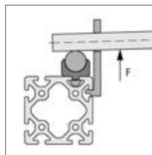
Bei längeren Strecken, deren Trägerprofile bereits montiert sind oder z. B. im Schraubstock gehalten werden, kann nach dem Eindrücken des Wellenklemmprofils die Welle unter Zuhilfenahme des Montagewinkels (Best.-Nr. 0.0.265.38) und eines entsprechenden Rundstahls als Hebel abschnittsweise in das Wellenklemmprofil eingepresst werden.
