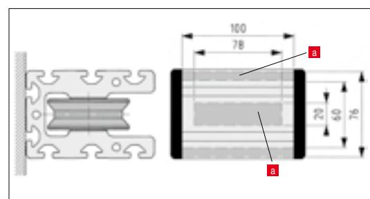
**a** Bereich bzw. Bohrung für Zylinderstift DIN 7979-6x32
