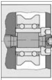
Die exzentrischen Lagereinheiten müssen vor dem Einsetzen des Führungswagens bezüglich ihrer Exzenterlage vorbereitet werden.
