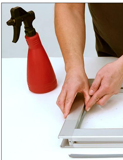
Die zugeschnittenen Dichtprofile 8 4-6mm, grau ähnlich RAL 7040 (0.0.489.92), fixieren und dichten das Flächenelement ab.
