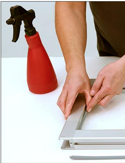
Die zugeschnittenen Dichtprofile 8 4-6 mm, grau ähnlich RAL 7040 (0.0.489.92), fixieren und dichten das Flächenelement ab. Wir empfehlen die Montage der Dichtprofile durch den Einsatz von Seifenlauge zu vereinfachen.
