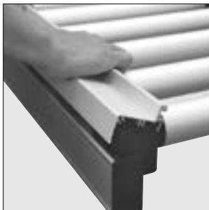
Die Ausführung des Gehäuseprofils mit Bordkante ermöglicht die seitliche Führung des Transportgutes auf der Rollenbahn, wobei in die integrierte Nut 5 der Bordkante z. B. eine Gleitleiste 5 eingesetzt oder andere Führungselemente daran verschraubt werden können.
