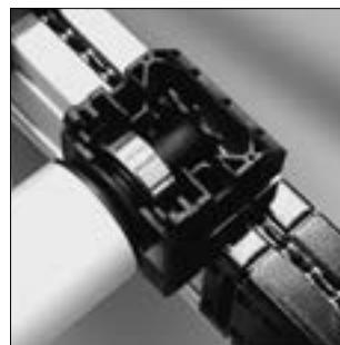
Die Lagerblöcke werden nach der Rollen-Montage durch das über die gesamte Rollenbahnlänge geführte Gehäuseprofil verschlossen. Dazu wird das Gehäuseprofil von der Rollenseite her auf die Lagerblöcke aufgesetzt und durch eine Schwenkbewegung verrastet (gelöst werden kann diese Verrastung durch Einsatz eines Schraubendrehers zum Aufhebeln).
