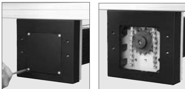
Die Kette ist innerhalb der Gegenumlenkung durch Abnehmen der Kunststoff-Abdeckkappen zugänglich. Es wird empfohlen, das Kettenschloss durch diese Wartungsöffnung innerhalb der Kettengegenumlenkung zu montieren.
