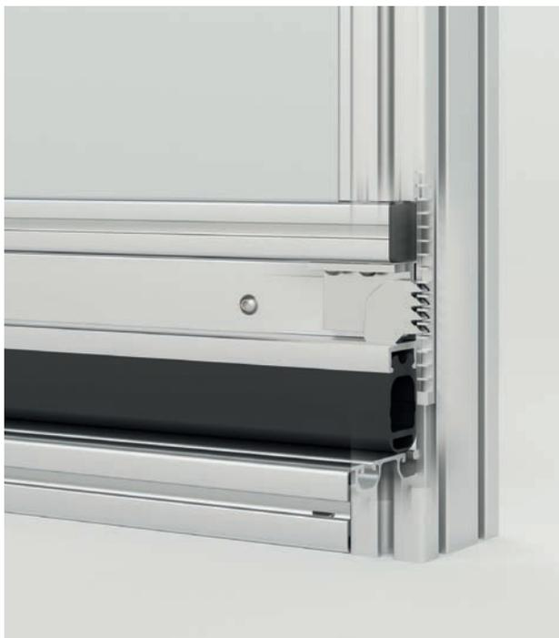
Das von KLEFINGHAUS neu entwickelte lock-System sorgt dafür, dass beim Auslösen der Kontaktleiste das bewegliche Türblatt mittels einer Verzahnung gegen den Rahmen mechanisch verriegelt wird. Verglichen mit den elektrischen kontaktbehafteten Schutzkontaktleisten sorgt das neue lock-System für ein deutlich schnelleres, direkteres und unkompliziertes Verriegeln der Hubtür.
