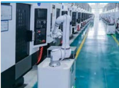
Maschinen-beschickung mit Standard FTF-Robotern
