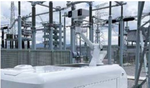
IR-Inspektion in elektrischen Kraftwerken
