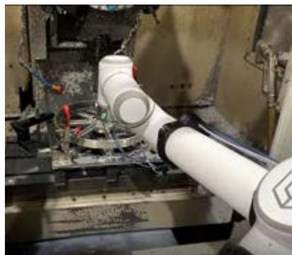
Be- und Entladen von Getrieben mit Maschinenbeschickung
