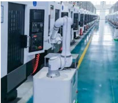
CNC-Maschinenbeschickung mit AGV
